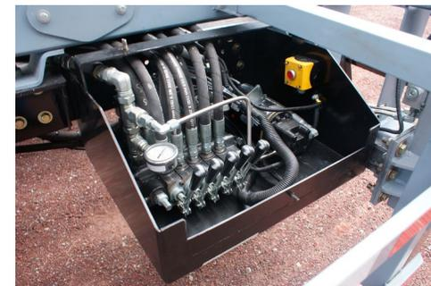
Caja de válvulas hidráulicas
